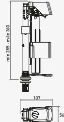
FLUSH FERRAGENS CISTERN MECHANISM
